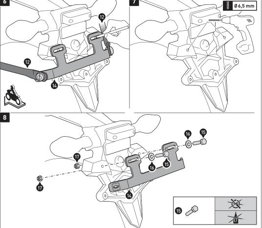
HINWEIS: Führen Sie die Schritte [6] und [7] nur durch, falls die Montagebohrungen des Kotflügels nicht mit dem Lochbild des Querverbinders (14) übereinstimmen.
