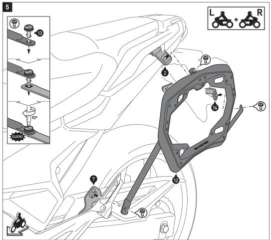
Verbinden Sie die beiden Kofferträger (12) mit den Befestigungslaschen (2) und (7); verwenden Sie die Schnellverschlüsse (13), wie in der Detailzeichnung gezeigt.
