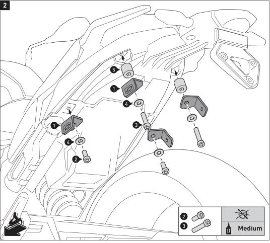
Verschrauben Sie die Befestigungs-laschen (1) am Fahrzeug, wie in der Zeichnung gezeigt. ACHTUNG: Verwenden Sie flüssige Schraubensicherung! Ziehen Sie die Schrauben noch nicht
