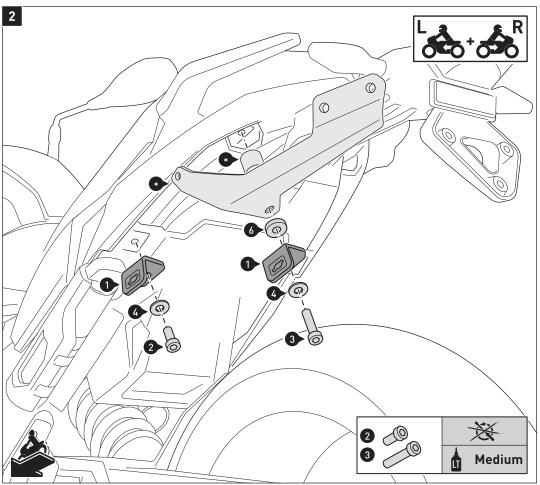
HINWEIS: Bei Verbau des Seitenträgers mit dem SW-MOTECH Street Rack, verwenden Sie die Buchse (\*) des Street Racks statt der Buchse (5).
