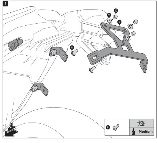
Verschrauben Sie den Querverbinder (7) an der Kennzeichenhalterung, wie in der Zeichnung
