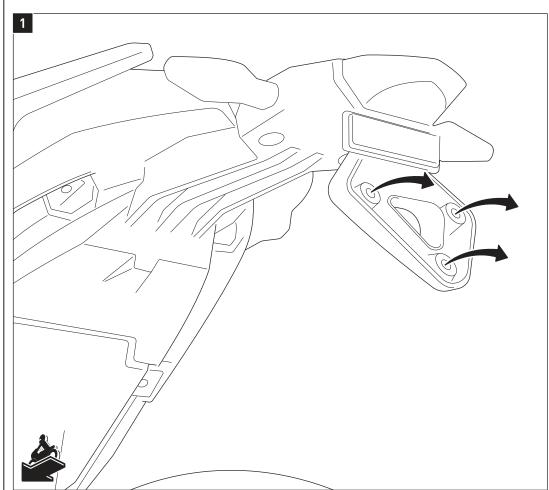
Entfernen Sie die Kunststoffdübel von der Kennzeichenhalterung, wie in der Zeichnung gezeigt,
