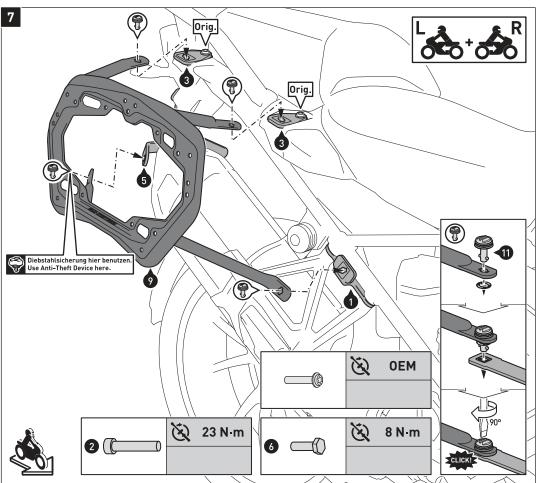
Verbinden Sie die Seitenträger (9) und (10) mit den Schnellverschlüssen (11) an den Befestigungslaschen und dem Querverbinder. Sichern Sie die Schnellverschlüsse mit den Sicherungsscheiben.
