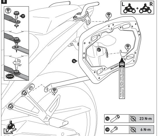
Verbinden Sie die Kofferträger (16) mit den Schnellverschlüssen (17) an den Befestigungslaschen und dem Querverbinder. Sichern Sie die Schnellverschlüsse (17) mit den Sicherungsscheiben.
