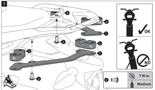
HINWEIS: Beachten Sie die eingefräste Nummerierung der Profilstücke (L8 / L9 / R8 / R9).
