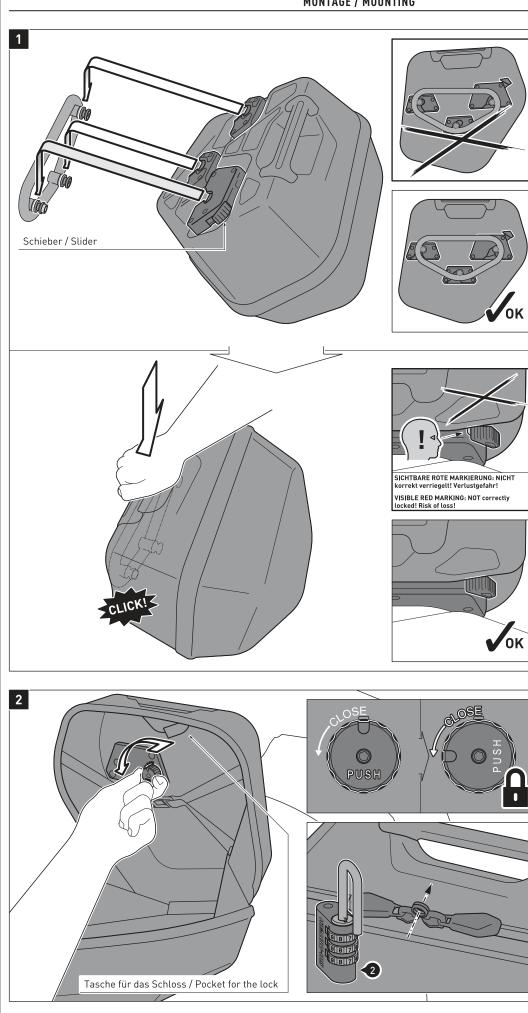
Setzen Sie die drei Arretierungsöffnungen des Seitenkoffers auf die Führungsbolzen des montierten SLC Seitenträgers. Drücken Sie anschließend den Seitenkoffer leicht nach unten, bis dieser fest am SLC Seitenträger sitzt.
