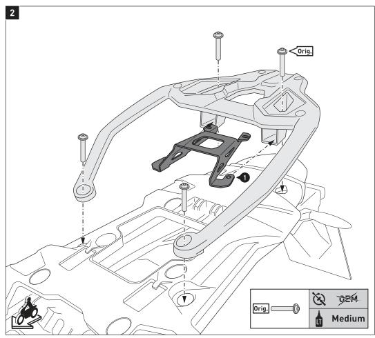
Verschrauben Sie das Anbaublech (1) mit dem Gepäckträger und den original Schrauben (Orig) am Fahrzeug, wie in der Zeichnung
