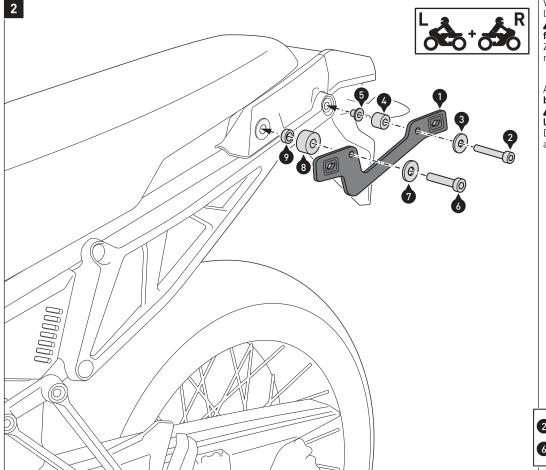
Verschrauben Sie die Befestigungs-laschen (1) **beidseitig** am Fahrzeug. **A WARNUNG:** Verwenden Sie flüssige Schraubensicherung!
