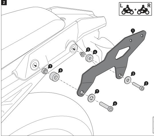
Montieren Sie die Anbaubleche (1) beidseitig am Fahrzeug.
