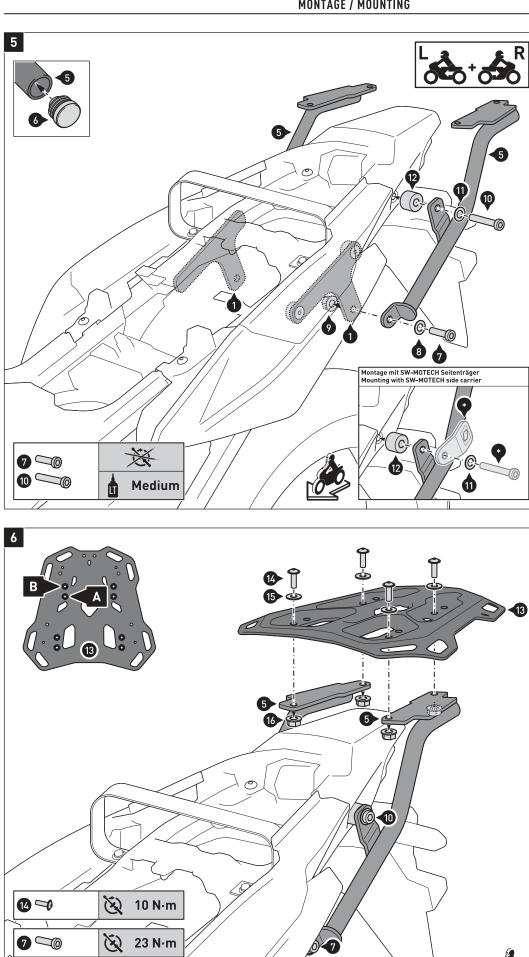
HINWEIS: Wenn der Gepäckträger mit dem SW-MOTECH Seitenträger montiert wird, entfallen die Schrauben (10). Montieren Sie stattdessen die markierten (\*) Teile des Gepäckträgers, wie in der Detailzeichnung gezeigt.
