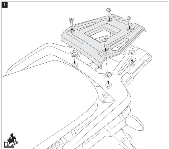
Lösen Sie die Schrauben und entfernen Sie den original Gepäckträger vom Fahrzeug, wie in der Zeichnung gezeigt.
