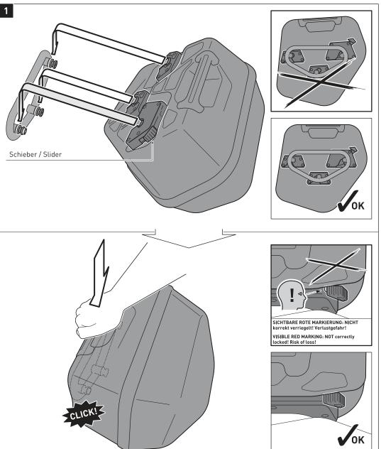
Setzen Sie die drei Arretierungsöffnungen des Seitenkoffers auf die Führungsbolzen des montierten SLC Seitenträgers. Drücken Sie anschließend den Seitenkoffer leicht nach unten, bis dieser fest am SLC Seitenträger sitzt.
