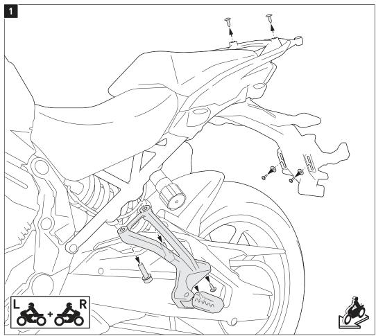
Entfernen Sie die original Schrauben, Fußrastenhalter und Kunsstoffdübel beidseitig vom Fahrzeug.
