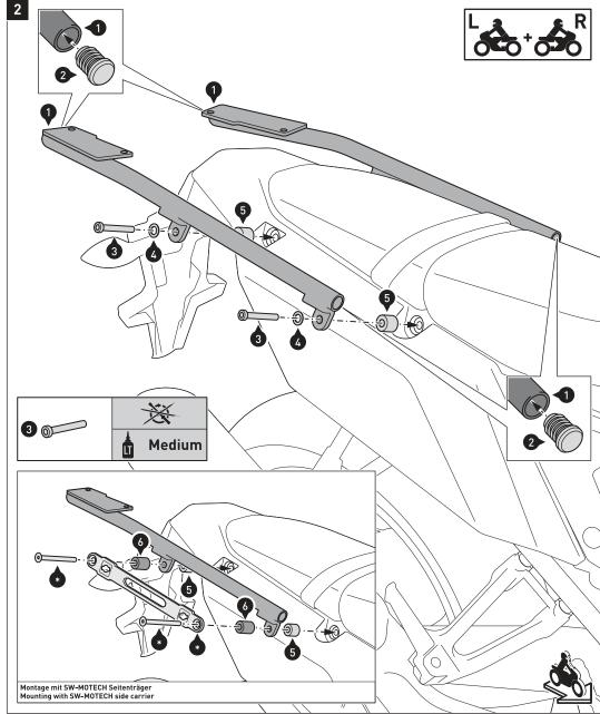
HINWEIS: Die Montage ist rechtsseitig dargestellt. Wiederholen Sie die Montage mit den entsprechenden Teilen auf der linken Fahrzeugseite analog zur rechten Fahrzeugseite.
