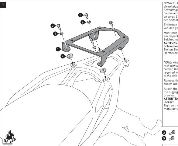
HINWEIS: Wenn der Gepäckträger in Verrbindung mit dem SW-MOTECH Seitenträger verbaut wird, entfallen die Distanzbuchsen (4). Verbauen Sie an deren Stelle den Querverbinder des Seitenträgers.
