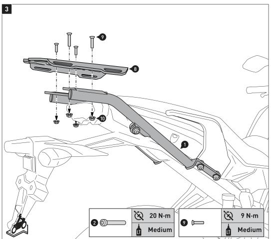
Verschrauben Sie den Gepäckträger (8) auf den Anbaustreben (1). ACHTUNG: Verwenden Sie flüssige Schraubensicherung!
