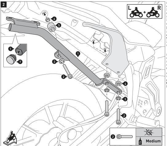
HINWEIS: Bei gleichzeitigem Verbau des Gepäckträgers mit dem SW-MOTECH Seitenträger, entfallen die Distanzbuchsen (4). Montieren Sie stattdessen die Anbaubleche des Seitenträgers.
