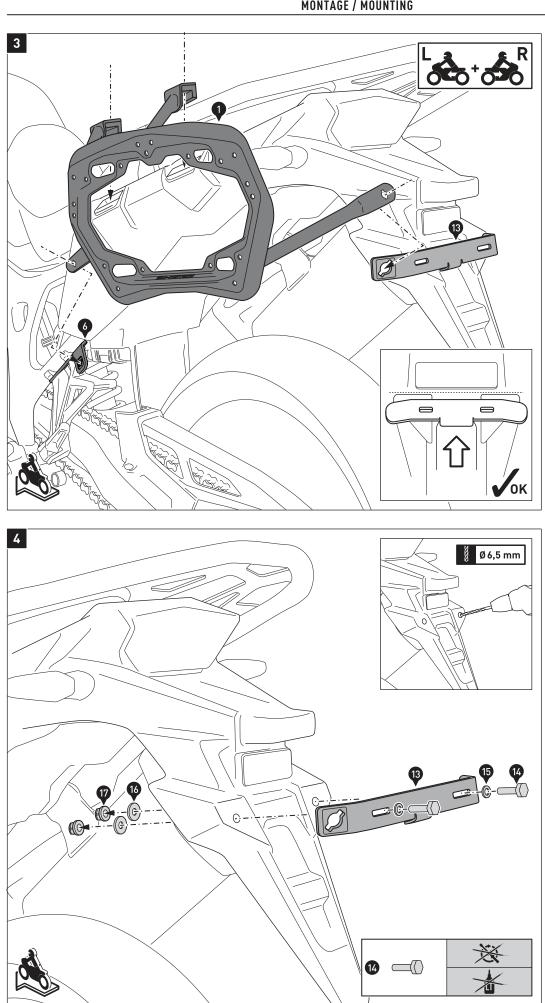
Hängen Sie die Seitenträger (1) beidseitig in die Heckmulden des Fahrzeugs und verbinden Sie diese mit den Schnellverschlüssen (18) am Querverbinder (13) und den Befestigungslaschen (6) und (9/10).
