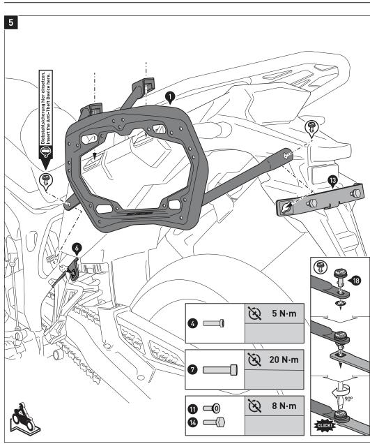
Verbinden Sie die Seitenträger [1] mit den Schnellverschlüssen [18] am Querverbinder [13] und den Befestigungslaschen (6) und (9/10). Sichern Sie die Schnellverschlüsse mit den Sicherungsscheiben.
