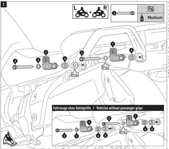
Entfernen Sie die Schrauben von den Haltegriffen, falls vorhanden.
