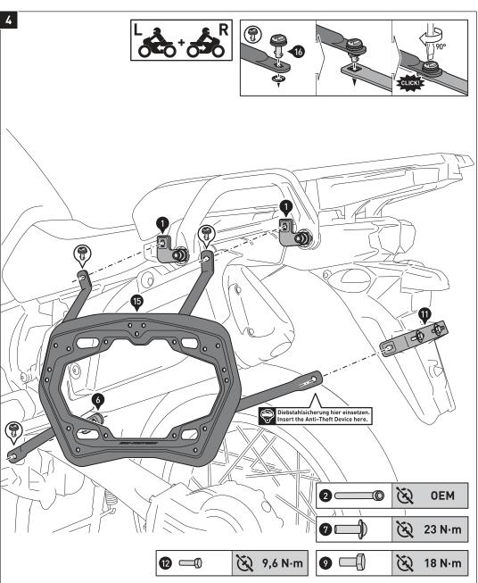
Verbinden Sie die Seitenträger (15) mit den Schnellverschlüssen (16) am Querverbinder (11) und den Befestigungslaschen (1) und (6). Sichern Sie die Schnellverschlüsse mit den Sicherungsscheiben.
