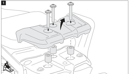
Lösen Sie die gezeigten Schrauben und entfernen Sie die Kunststoffabdeckung und die Distanzbuchsen vom Fahrzeug.
