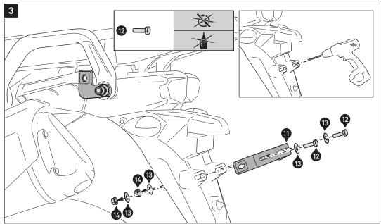
Bohren Sie zwei Löcher mit einem Durchmesser von 6,5 mm in den Kotflügel, wie in der Detailzeichnung gezeigt.
