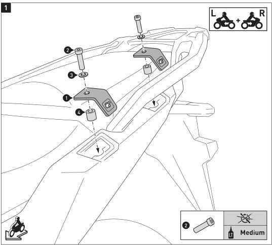
Entfernen Sie die Schrauben auf beiden Seiten des Fahrzeugs von den Anbaupunkten.
