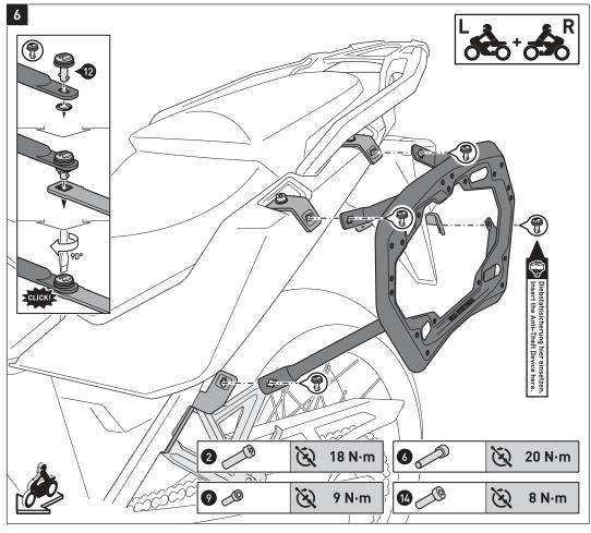
Verbinden Sie die Kofferträger [11] mit den Schnellverschlüssen [12] an den Befestigungslaschen [1] und [5]/(8) und dem Querverbinder [13]. Sichern Sie die Schnellverschlüsse mit den Sicherungsscheiben.
