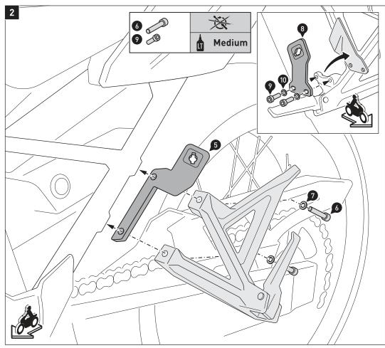
Entfernen Sie auf der linken Fahrzeugseite die Fußraste vom Fahrzeug.
