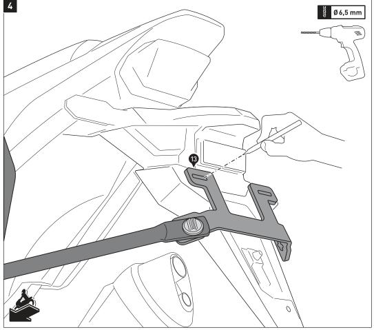
Markieren Sie mit einem geeigneten Stift die Befestigungsbohrungen des Querverbinders (13) auf dem Kotflügel.
