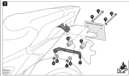
Verschrauben Sie den Querverbinder (14) am Kotflügel, wie in der Zeichnung gezeigt. Ziehen Sie die Schrauben noch nicht an.
