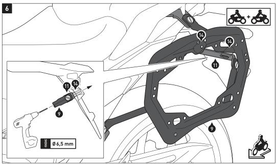
A HINWEIS: Führen Sie die Schritte [6] und [7] nur durch, falls die Montagebohrungen des Kotflügels nicht mit dem Lochbild des Querverbinders [11] übereinstimmen.
