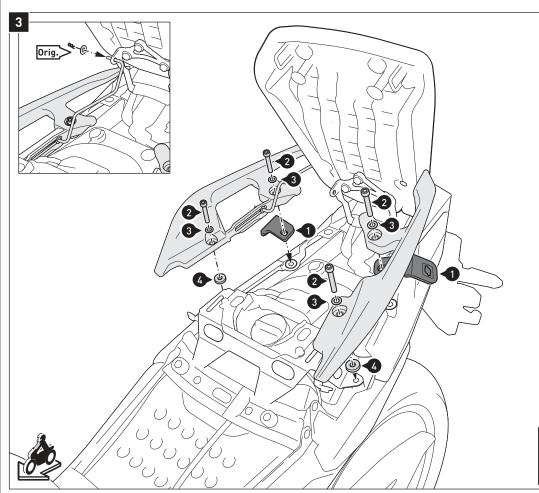
Verschrauben Sie die Befestigungslaschen (1) mit den Sozius-Haltegriffen am Fahrzeug, wie in der Zeichnung gezeigt. Halten Sie die Distanzbuchsen (4) mit etwas Fett in Position.
