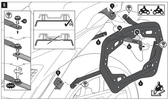
Verbinden Sie die beiden Kofferträger (9) mit den Befestigungslaschen (1) und (5); verwenden Sie die Schnellverschlüsse (10), wie in der Detailzeichnung gezeigt.
