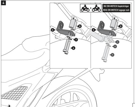
⚠ HINWEIS: Bei gleichzeitig montiertem SW-MOTECH Gepäckträger entfallen die Schrauben (6) und Unterlegscheiben (7). Verwenden Sie stattdessen die Teile (\*) des Gepäckträgers. Montieren Sie die Haltestreben des Gepäckträgers zwischen den Befestigungslaschen (5) und Unterlegscheiben (\*).
