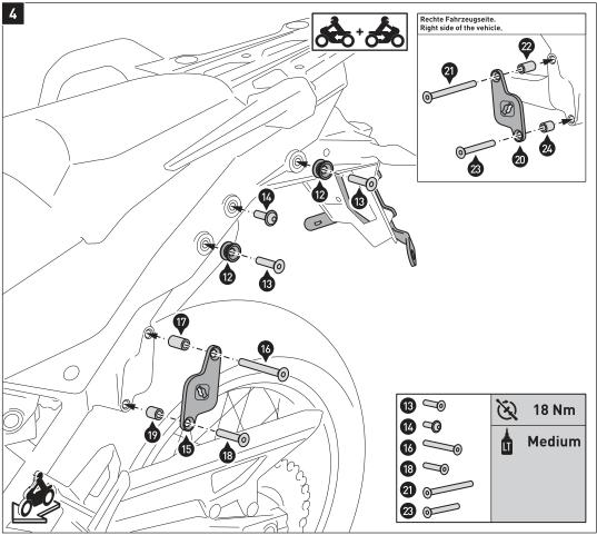
HINWEIS: Die Befestigungslaschen (15) und (20) sind asymmetrisch aufgebaut. Achten Sie bei der Montage darauf, dass die kürze Anbaupunkt der Befestigungslaschen (15) und (20) nach unten zeigt, wie in der Zeichnung und Detailzeichnung gezeigt.
