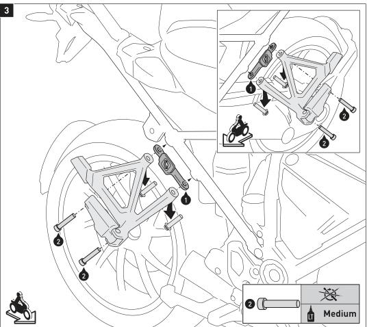
Lösen Sie Schrauben der Soziusfußrasten und entfernen Sie diese vom Fahrzeug.
