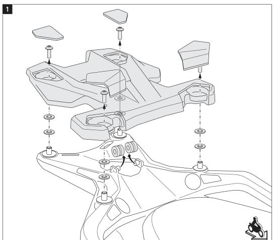
Lösen Sie die gezeigten Teile und entfernen Sie den original Topcase-Träger vom Fahrzeug.
