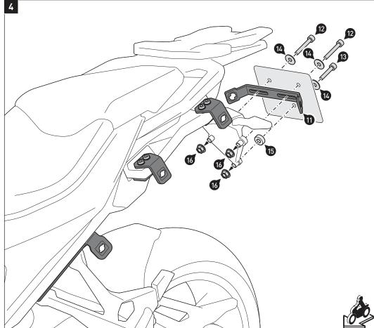
Verschrauben Sie den Querverbinder [11] am Nummernschildhalter, wie in der Zeichnung gezeigt. Ziehen Sie die Schrauben noch nicht
