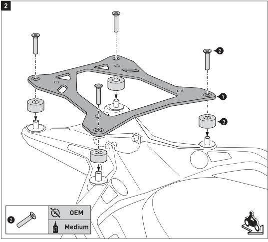
Montieren Sie das Anbaublech (1) am Fahrzeug, wie in der Zeichnung
