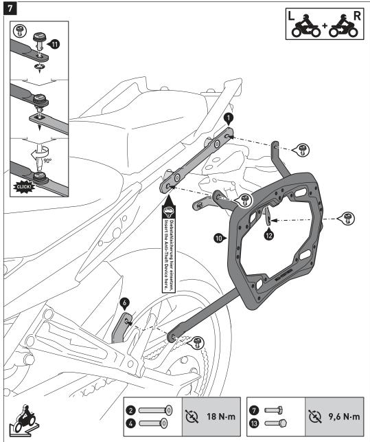
Verbinden Sie die Seitenträger (10) mit den Schnellverschlüssen (11) an den Befestigungslaschen und dem Querverbinder. Sichern Sie die Schnellverschlüsse mit den Sicherungsscheiben.
