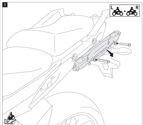
Entfernen Sie beidseitig die original Kofferaufnahmen vom Fahrzeug.
