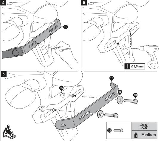
HINWEIS: Führen Sie die Schritte [4] & [5] nur durch, falls die Montagebohrungen des Kotflügels nicht mit dem Lochbild des Querverbinders (12) übereinstimmen.
