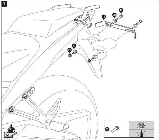
Verschrauben Sie den Querverbinder (18) am Kennzeichenhalter, wie in der Zeichnung gezeigt. Ziehen Sie die Schrauben noch nicht an
