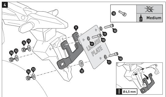
A HINWEIS: Falls die Montagebohrungen des Kotflügels nicht mit dem Lochbild des Querverbinders (9) übereinstimmen, bohren Sie mit einem 6,5-mm-Bohrer die Befestigungsbohrungen des Querverbinders. Entgraten Sie die Ränder der
