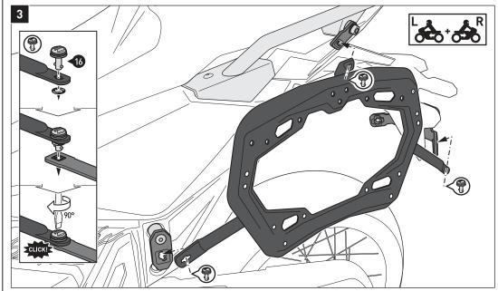
Verbinden Sie die Seitenträger (15) mit den Schnellverschlüssen (16) an den Befestigungslaschen (1) und (6) und dem Querverbinder (9). Sichern Sie die Schnellverschlüsse mit den Sicherungsscheiben.
