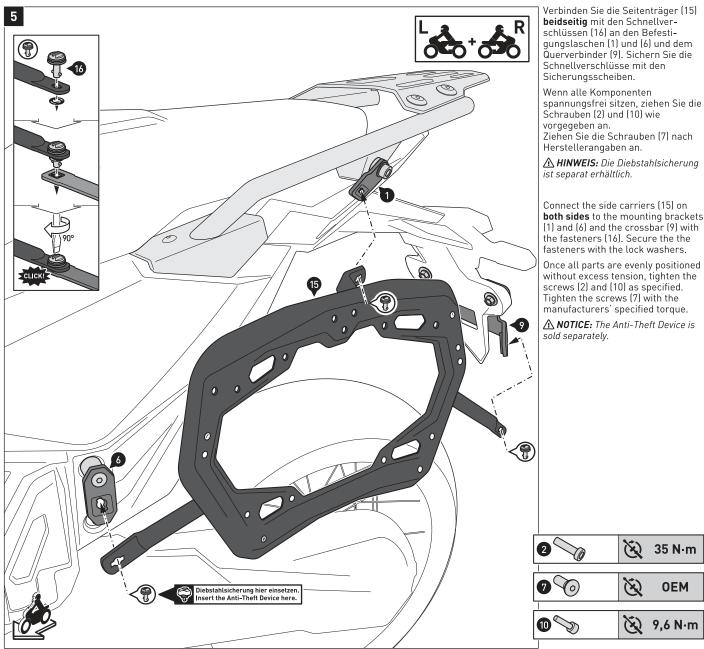
gungslaschen (1) und (6) und dem Querverbinder (9). Sichern Sie die Schnellverschlüsse mit den Sicherungsscheiben. Wenn alle Komponenten
