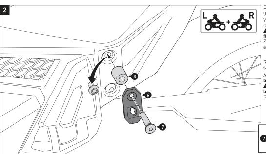
Entfernen Sie **beidseitig** die gezeigte Schrauben.
