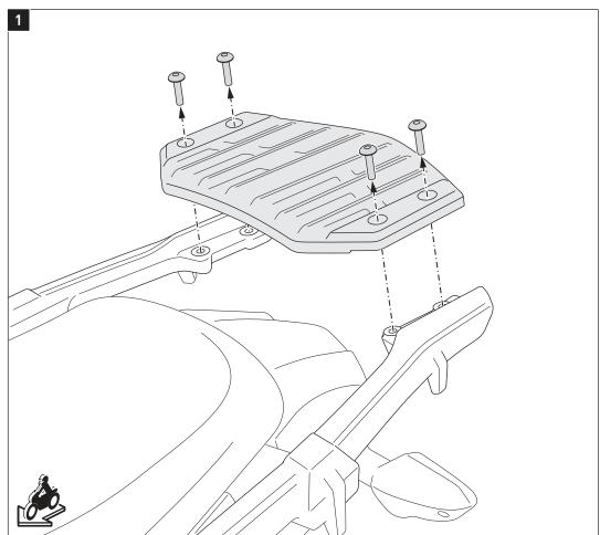
Lösen Sie die gezeigten Schrauben und entfernen Sie den Gepäck-träger vom Fahrzeug.
