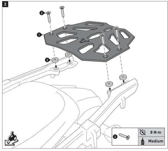
Verschrauben Sie den Gepäckträger (1) am Fahrzeug, wie in der Zeichnung gezeigt. ACHTUNG: Verwenden Sie flüssige Schraubensicherung! Ziehen Sie die Schrauben wie vorgegeben an.
