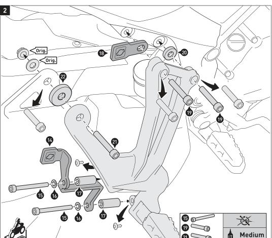
Entfernen Sie die gezeigten Schrauben und Kunststoffkappen von der **rechten** Soziusfußraste und dem Auspuffhalteblech. Verschrauben Sie nun die Befestigungslaschen (14) und (18) an bzw. hinter der Soziusfußraste, wie in der Zeichnung gezeigt.
