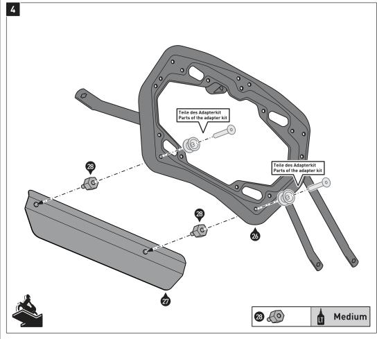
Verschrauben Sie das Hitzeschutz-blech (27) mit den Teilen Ihres Adapterkit am rechten Seitenträger (26), wie in der Zeichnung gezeigt (Beispielabbildung; die Teile variieren je nach Adapterkit). ACHTUNG: Verwenden Sie flüssige Schraubensicherung!
