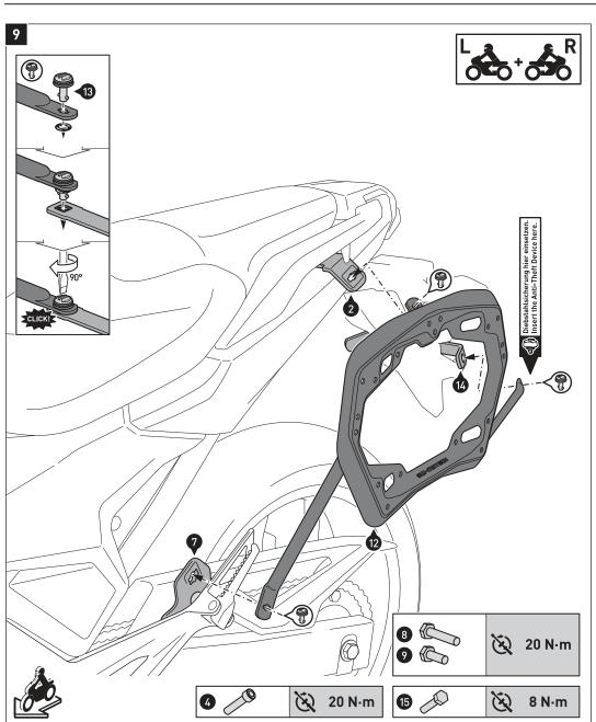
Verbinden Sie die Kofferträger (12) mit den Schnellverschlüssen (13) an den Befestigungslaschen (2) und (7) und dem Querverbinder (14). Sichern Sie die Schnellverschlüsse mit den Sicherungsscheiben.
