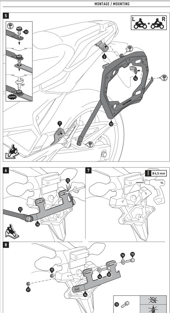
Verbinden Sie die beiden Kofferträger (12) mit den Befestigungslaschen (2) und (7); verwenden Sie die Schnellverschlüsse (13), wie in der Detailzeichnung gezeigt.
