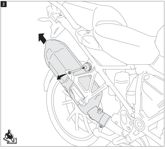
Lösen Sie die gezeigte Auspuff-Halteschraube und Auspuffschelle. Entfernen Sie den Endtopf vorsichtig vom Fahrzeug.
