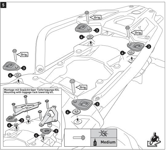
HINWEIS: Beachten Sie die in der Detailzeichnung gezeigte Verbausitu-ation mit den SW-MOTECH Gepäckträger Tieferlegungs-Kit. Dabei entfallen die vorderen Distanzbuchsen des Tieferlegungs-
