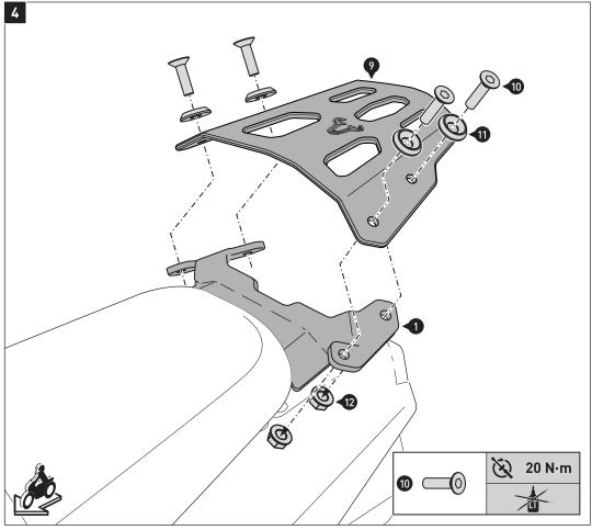
Verschrauben Sie die in Schrit [1] demontierten Teile in umgekehrter Reihenfolge wieder am Fahrzeug.
