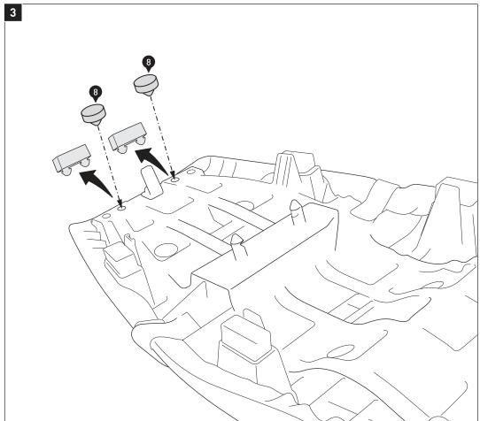
Ersetzen Sie die beiden hinteren Gummiblöcke der Sitzbank durch die Gummidämpfer (8), wie in der Zeichnung gezeigt.
