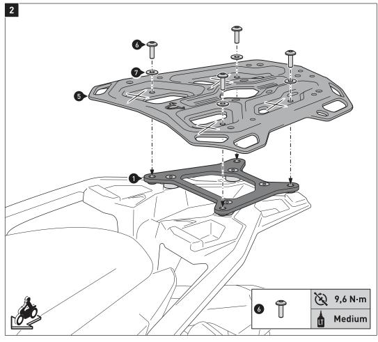
Verschrauben Sie den Gepäckträger (5) an der **hinteren** Montageposition am Anbaublech (1), wie in der Zeichnung gezeigt. **ACHTUNG: Verwenden Sie flüssige**
