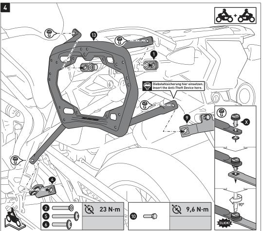
Verbinden Sie die Seitenträger (13) mit den Schnellverschlüssen (14) am Querverbinder (9) und den Anbaublechen (1) und (4). Sichern Sie die Schnellverschlüsse mit den Sicherungsscheiben.
