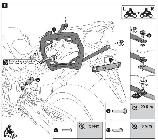
Verbinden Sie die Seitenträger (1) mit den Schnellverschlüssen (15) am Querverbinder (10) und den Befestigungslaschen (6). Sichern Sie die Schnellverschlüsse mit den Sicherungsscheiben.
