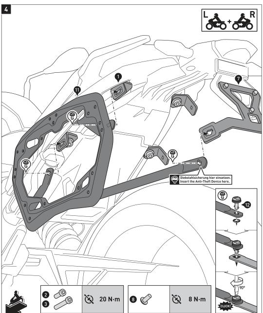
Verbinden Sie die Seitenträger [11] mit den Schnellverschlüssen [12] an den Befestigungslaschen [1] und dem Querverbinder [7]. Sichern Sie die Schnellverschlüsse mit den Sicherungsscheiben.
