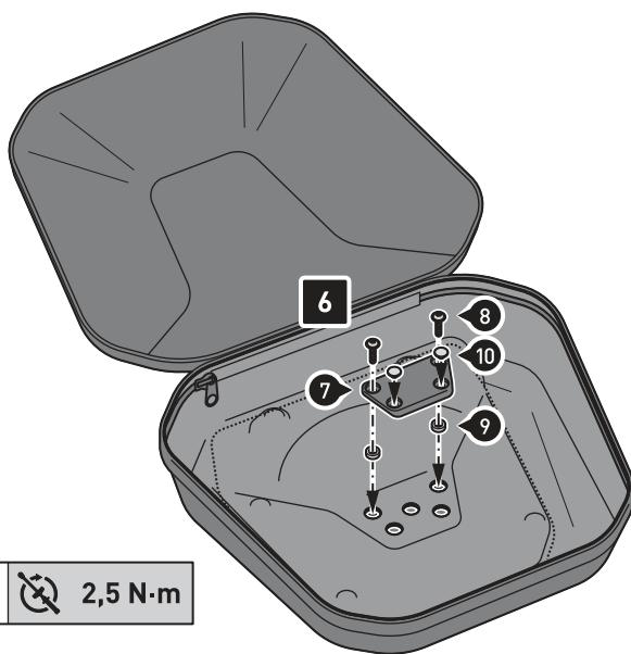
**Schritt [6]:** Verschrauben Sie die Abdeckplatte (7) im Topcase (1). Ziehen Sie die Schrauben wie in der Stückliste vorgegeben an.
