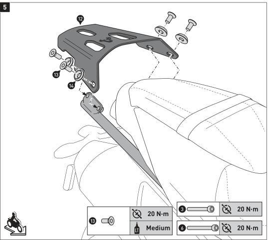
Verschrauben Sie den Gepäckträger (12) an den Rohrstreben (5), wie in der Zeichnung gezeigt. ACHTUNG: Verwenden Sie flüssige Schraubensicherung!
