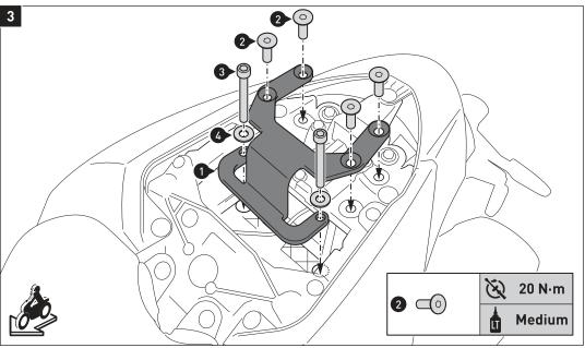
Montieren Sie den Anbauwinkel (1) am Fahrzeug, wie in der Zeichnung gezeigt
