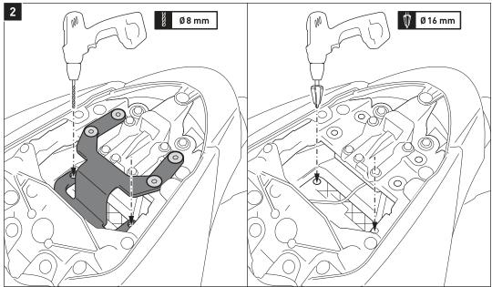
Nutzen Sie die unteren Verschraubpunkte des Anbauwinkels (1) als Bohrschablone, um zwei 8 mm Pilotbohrungen durch die Kunststoffverkleidung des Fahrzeugs zu bohren.
