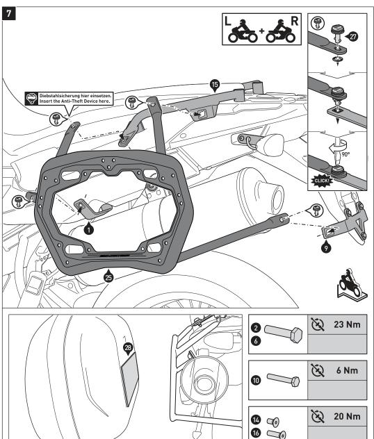
Verbinden Sie die Seitenträger (25) und (26) mit den Schnellverschlüssen (27) an den Befestigungslaschen (1) und (5), dem Querverbinder (9) und dem Haltegriff (15). Sichern Sie die Schnellverschlüsse (27) mit den Sicherungsscheiben.
