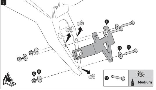
Entfernen Sie die original Steckmuttern vom Kennzeichenhalter.
