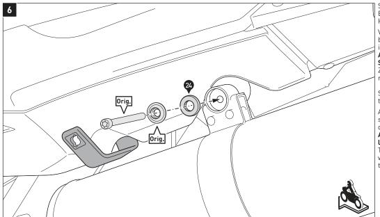
Stützen Sie den Endtopf ab. Entfernen Sie anschließend die Halteschraube.
