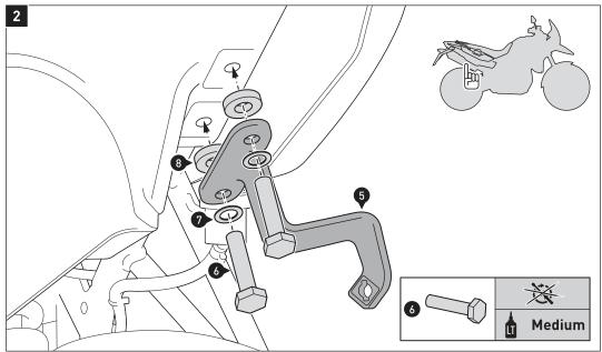
Montieren Sie die Befestigungslasche (5) am Fahrzeugrahmen (rechte Fahrzeugseite), wie in den Zeichnungen gezeigt.
