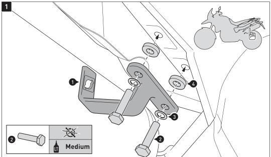
Montieren Sie die Befestigungslasche (1) am Fahrzeugrahmen (linke Fahrzeugseite), wie in den Zeichnungen gezeigt.
