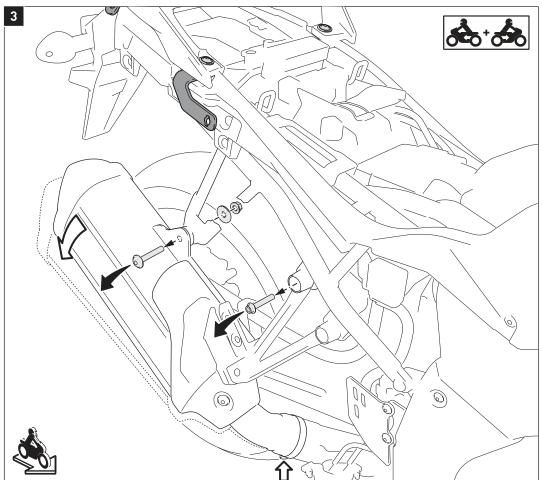
Entfernen Sie beidseitig die gezeigten original Schrauben.
