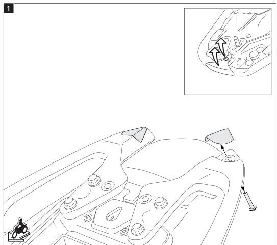
Entfernen Sie die original Teile und Schrauben von den Anbaupunkten. Entfernen Sie die in der Detailzeichnung gezeigte original Kunststoff-abdeckung von der Sitzbank.
