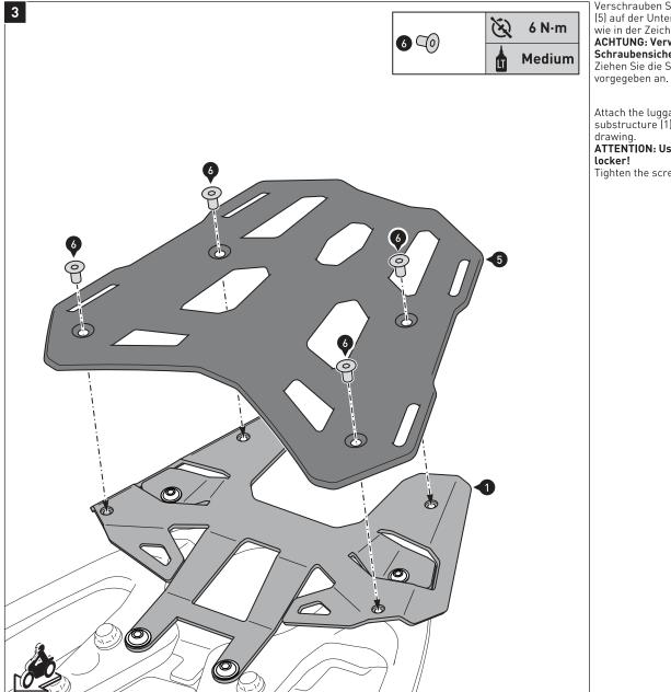
Verschrauben Sie den Gepäckträger (5) auf der Unterkonstruktion (1), wie in der Zeichnung gezeigt. ACHTUNG: Verwenden Sie flüssige
