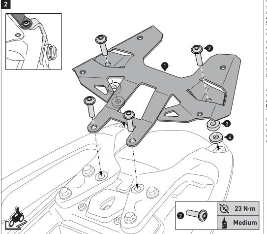
Verschrauben Sie die Unterkon-struktion (1) am Fahrzeug, wie in der Zeichnung gezeigt. ACHTUNG: Verwenden Sie flüssige Schraubensicherung!
