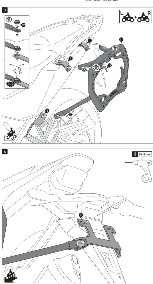
Verbinden Sie die Kofferträger (11) mit den Schnellverschlüssen (12) an den Befestigungslaschen (1) und (5)/(8), sowie dem Querverbinder (13).
