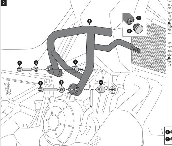
Setzen Sie den Kunststoffstopfen (8) in die Öffnung des Sturzbüges (1) ein
