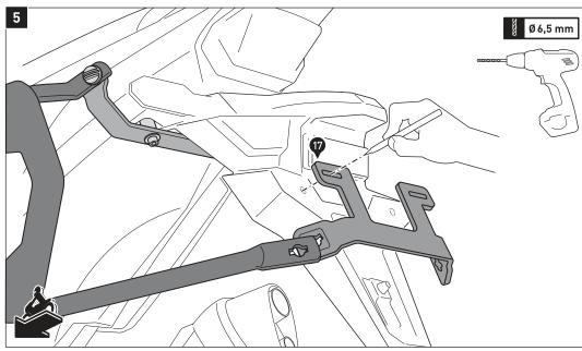
Markieren Sie mit einem geeigneten Stift die Befestigungsbohrungen des Querverbinders (17) auf dem Kotflügel. Lösen Sie anschließend die Schnellverschlüsse (16) und entfernen Sie den Querverbinder (17) und die Kofferträger (15) vom Fahrzeug. Bohren Sie mit einem 6,5-mm-Bohrer die Befestigungsbohrungen des
