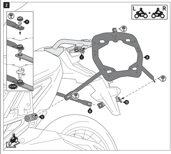
Verbinden Sie die beiden Seitenträger (8) mit den Befestigungslaschen (1) und (5); verwenden Sie die Schnellverschlüsse (9) wie in der Detailzeichnung gezeigt. Verbinden Sie anschließend die hinteren Befestigungsausleger mit dem Querverbinder (10). Verwenden Sie auch hier die Schnellverschlüssen (0)
