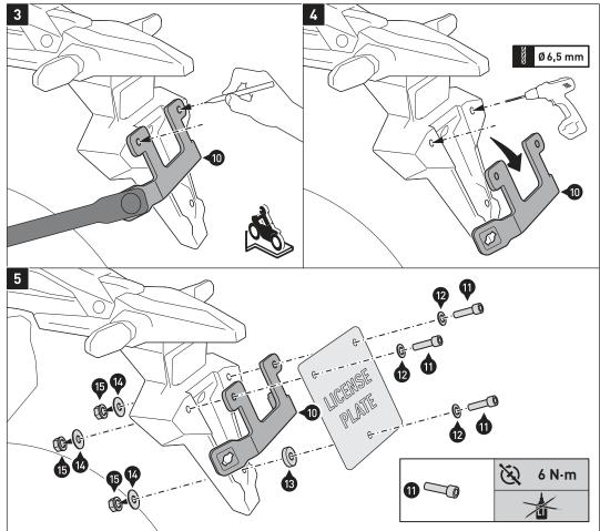
HINWEIS: Führen Sie die Schritte [3] und [4] nur durch, falls die Montagebohrungen des Kotflügels nicht mit dem Lochbild des Querverbinders (10) übereinstimmen.
