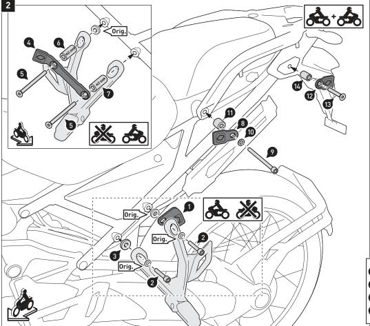
Verschrauben Sie die Befestigungslaschen (1), (4), (8) und (12) **beidseitig** mit den gezeigten original Unterlegscheiben und Buchsen (Orig.)am Fahrzeug.
