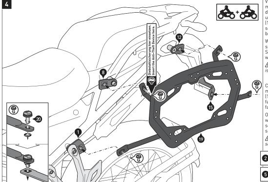
Verbinden Sie die Seitenträger [19] mit den Schnellverschlüssen [20] an den Befestigungslaschen [1], [4], [8] und [12] und dem Querverbinder [15]. Sichern Sie die Schnellverschlüsse mit den Sicherungsschei-
